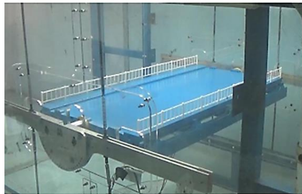
Gambar 9. Instalasi model di dalam terowongan angin
