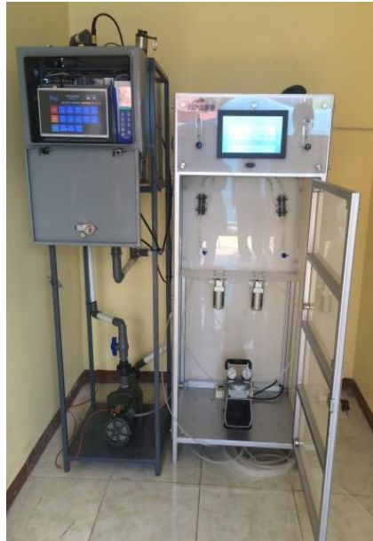
Gambar 6. Sistem Peralatan Telemetry SIPAKU Dan ONLIMO Telah Terpasang di Pos Pemantau Sungai Cisadane, Kota Tangerang
