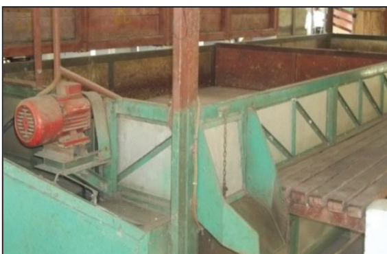
Gambar 2. Mesin Pengerih Biji Kakao Tipe Bak.
