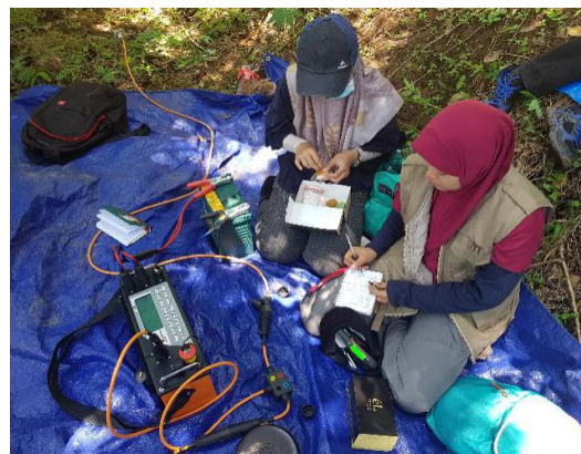
Gambar 2. Pengukuran geolistrik dan instrumen geolistrik ARES yang digunakan untuk pengukuran di lapangan
