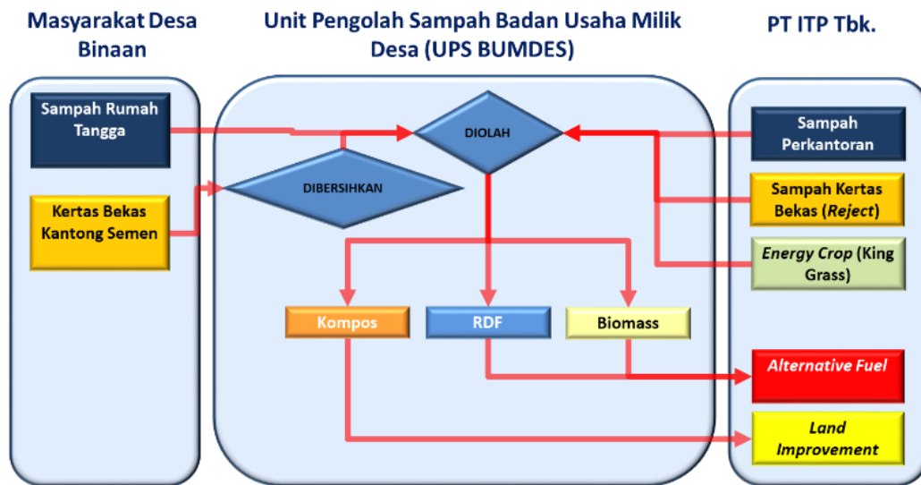
Gambar 4. Alur proses pengolahan sampah UPS Bumdes Palimanan Barat
