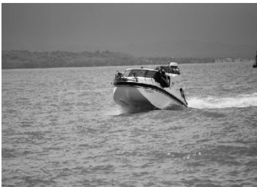
Gbr 7. Kondisi sinkage pada kecepatan 24 knots
